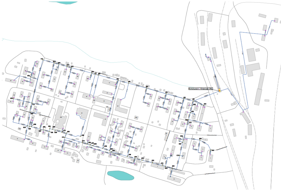
Рисунок 4. Схема тепловых сетей п. Юганская Обь от котельной п. Юганская Обь, промзона, строение 1
